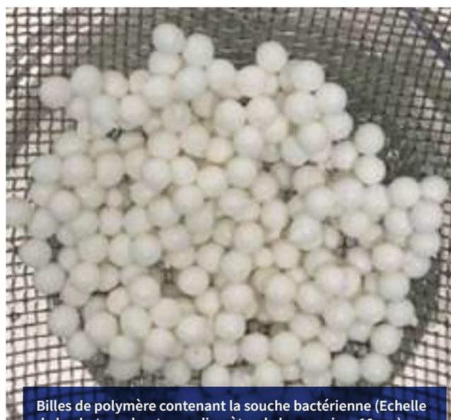
Billes de polymère contenant la souche bactérienne (Echelle de la photo en hauteur = diamètre de la passoire : 10 cm)
