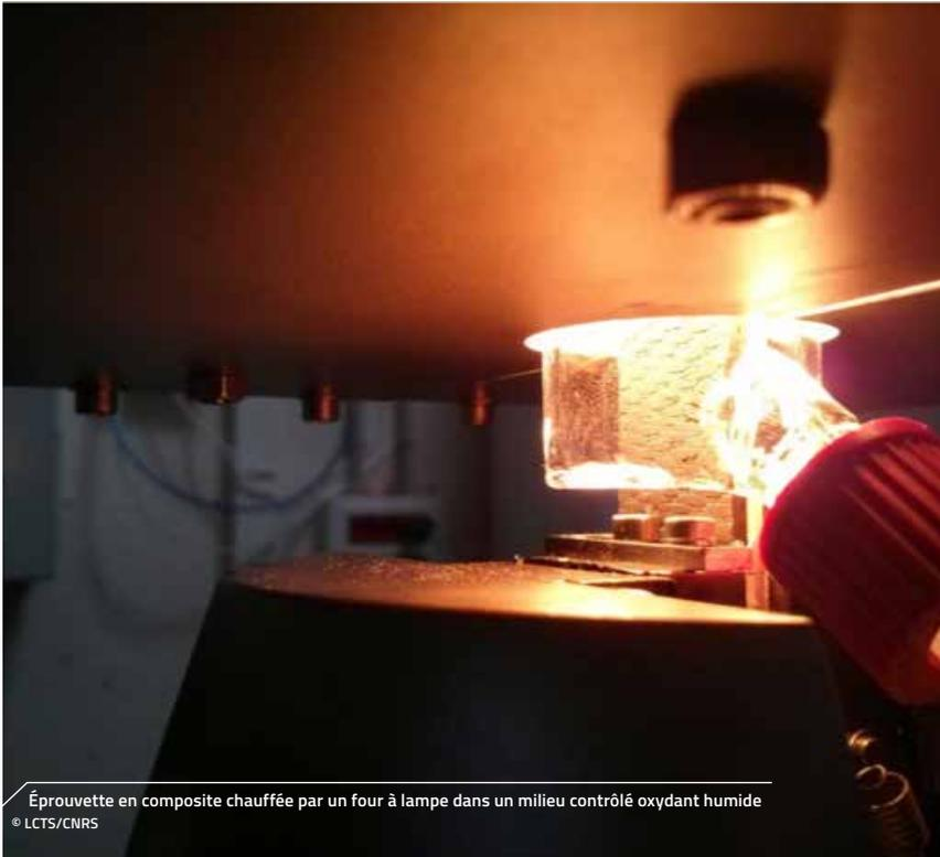
Éprouvette en composite chauffée par un four à lampe dans un milieu contrôlé oxydant humide
